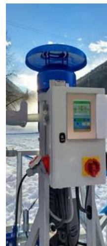
Ilustración 12. Sistema de control de volumen y caudal propio del cañón.
